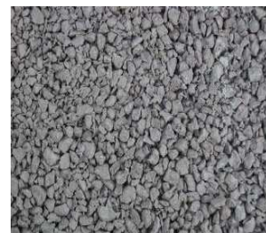
トラスト製骨材 (PET,PP,発泡ウレタン)
