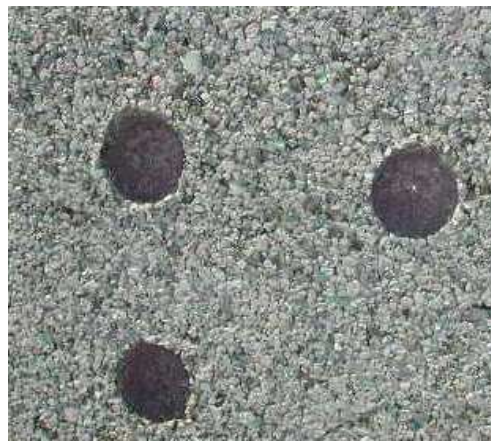
穴部拡大(直径:40mm、深さ:20mm、角度:45° )
